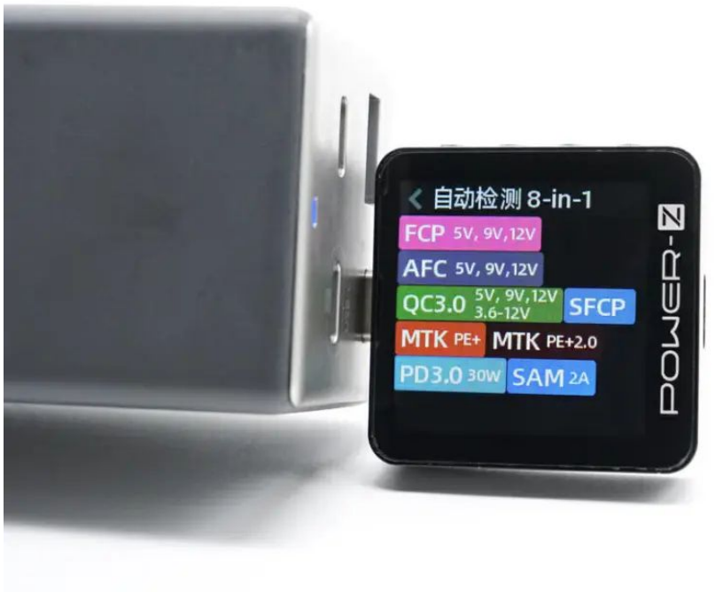
实测USB-C3端口支持FCP、AFC、QC3.0、SFCP、MTK 和 PD3.0 等快充协议。
