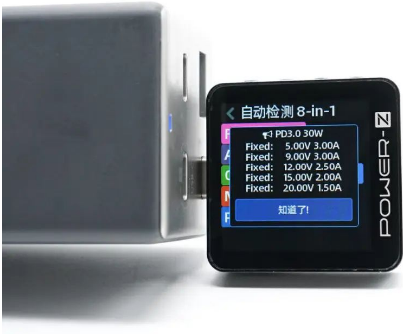
此外还支持 5V3A、9V3A、12V2.5A、15V2A和20V1.5A五组固定电压档位。
